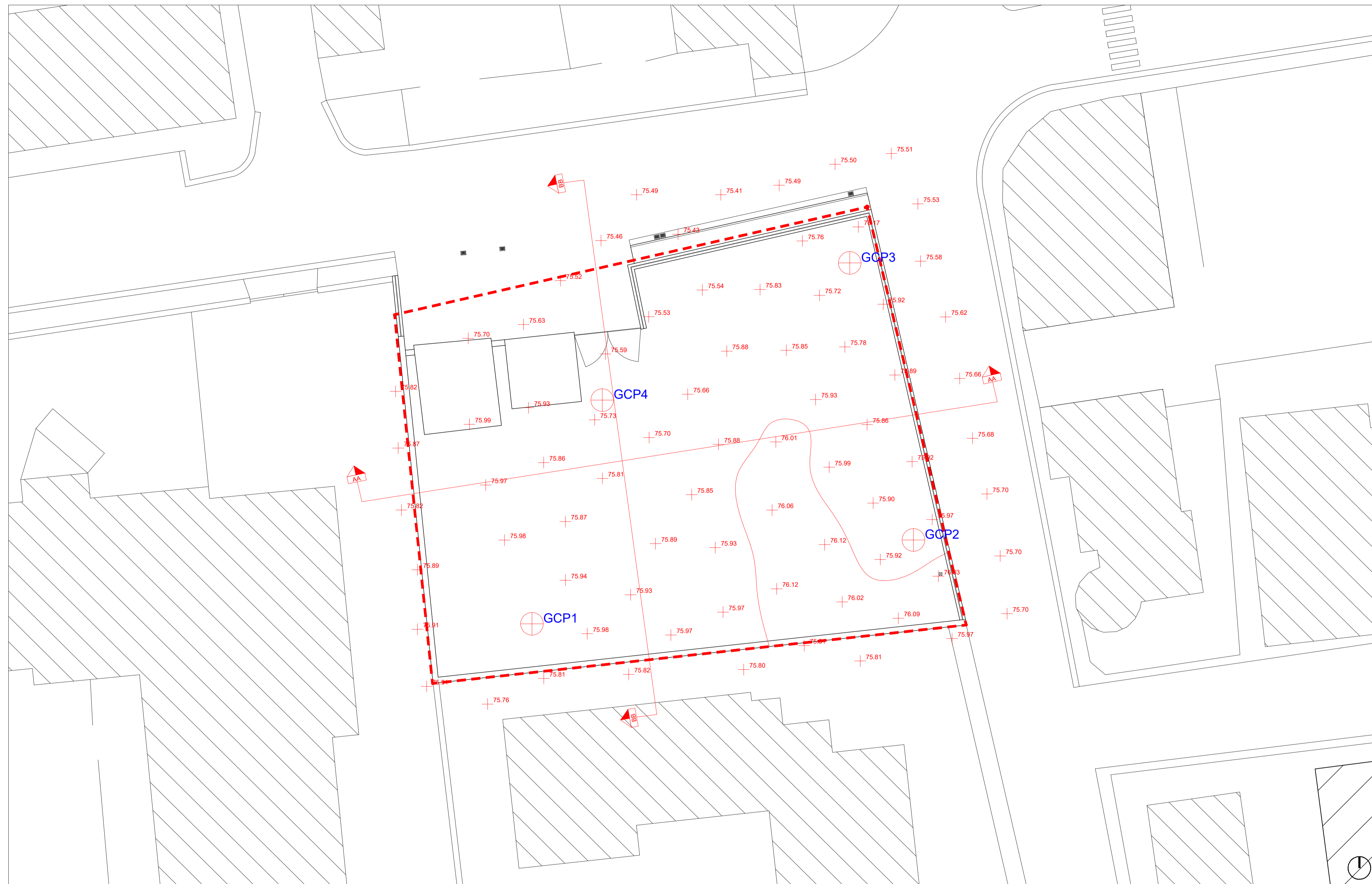
Rilievo piano altimetrico - stato di fatto - scala 1:200
